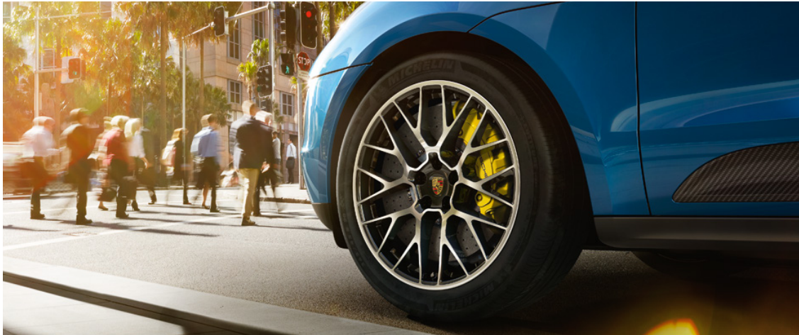
Freins céramique PCCB (Porsche Ceramic Composite Brake) du Macan S
