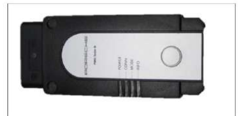
Interface de communication véhicule (VCI)
