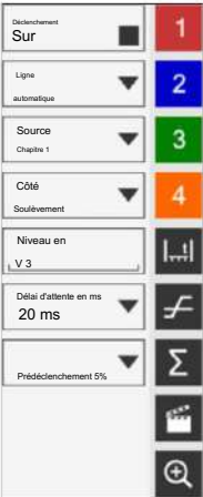
Fonctions de déclenchement 9_50_16
