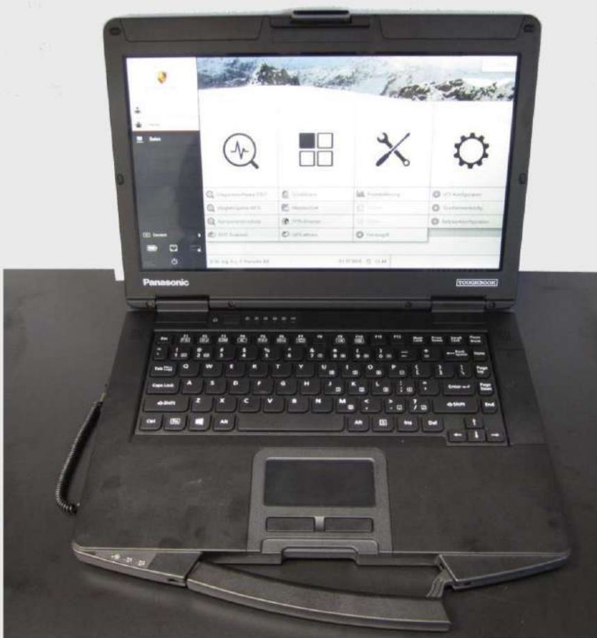
Vue de face du testeur PIWIS
